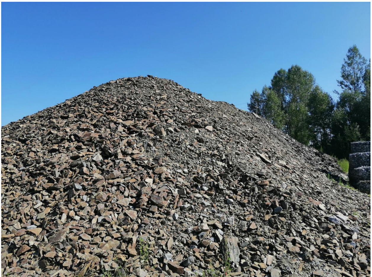
Грунт для возведения тела насыпи земляного полотна мостового сооружения
