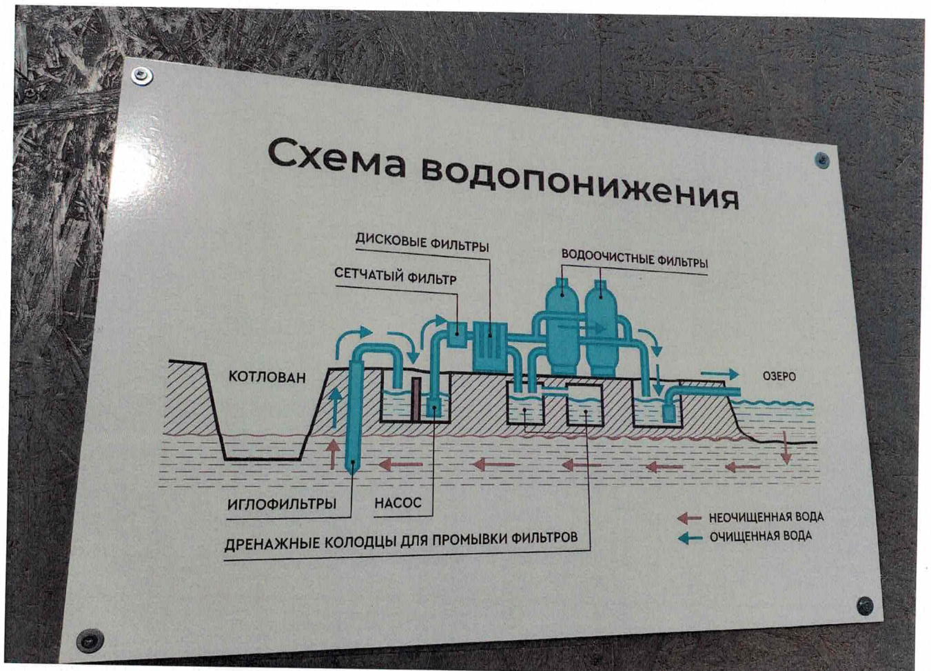
Система фильтрации и дренажа для отвода воды в озеро
